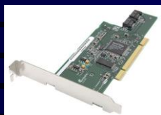
Rozhraní SATA se dvěma kanály (32-bit PCI)
