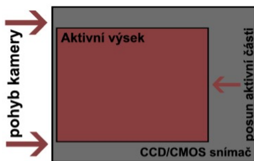
3.7.1.1 – El. stabilizace (reakce na pohyb)
